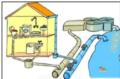
Pour éviter qu'en cas d'orage l'eau de pluie arrive en masse dans les stations d'épuration (STEP), ce qui entrave ou empêche complètement l'épuration de l'eau, la loi suisse sur la protection des eaux demande de séparer le réseau des eaux usées de celui des eaux de pluie (réseau séparatif par opposition au réseau unitaire qui mélange les deux sources).
